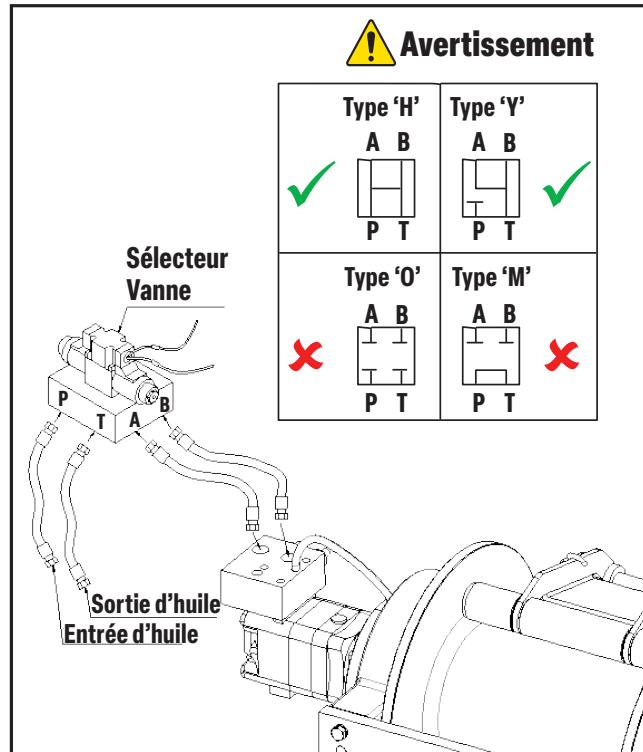
Les vannes de commande hydrauliques sont un élément essentiel pour optimiser les performances des systèmes. Elles sont utilisées pour
