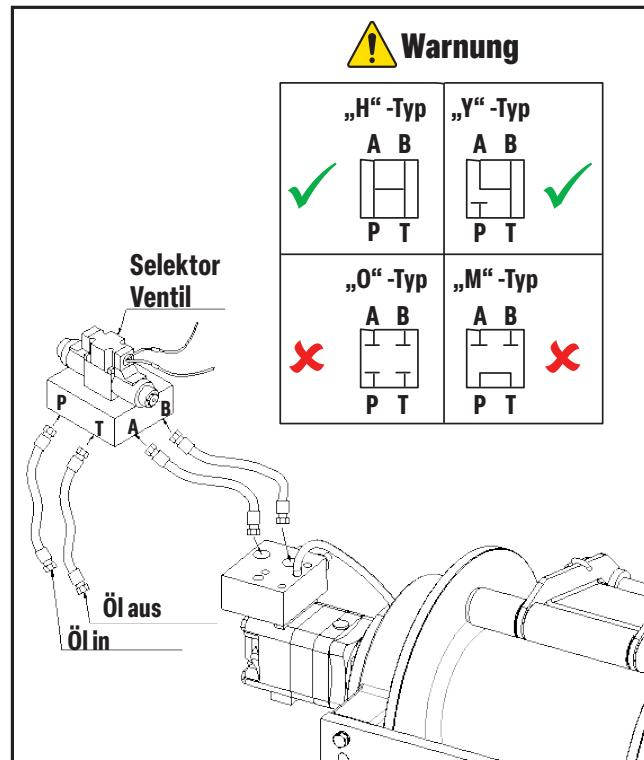
Hydraulische Steuerventile sind eine wesentliche Komponente zur Optimierung der Systemleistung. Sie werden verwendet, um die Durchflussrate und den Druck des Hydrauliköls zu regulieren, wenn es durch Schläuche oder Rohre fließt, und dabei immer die Geschwindigkeit und den Druck aufrecht zu erhalten.
