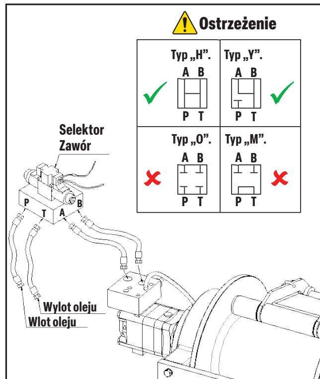
Hydraulicne zawory sterujące są niezbędnym elementem optymalizacji wydajności systemu. Służą do regulacji natężenia przepływu i ciśnienia oleju hydraulicznego, gdy przechodzi on przez węże lub rury, zawsze utrzymując prędkość i ciśnienie.
